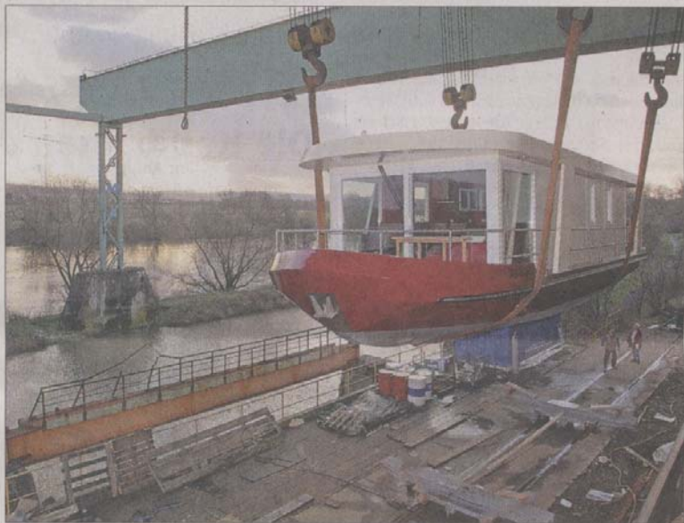
Hausboot am Haken: Bei der Firma Bick und Letzel in Nilkheim wird die »AQ 1500« zu Wasser gelassen.
